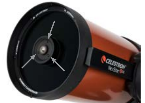
Tornillos de ajuste de colimado del espejo secundario
