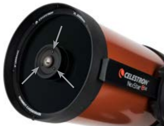
Vis d'ajustement de collimation du miroir secondaire
