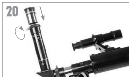
20 Introduzca el cañón del ocular de 20mm en la lente Barlow y apriete los tornillos para asegurarlo en posición.
