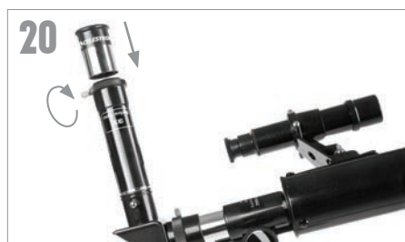
Insérez le barillet de l'oculaire de 20 mm dans la lentille de Barlow et serrez les vis pour le maintenir en place.
