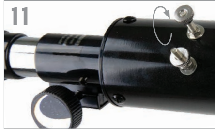
11 Saque las roscas del localizador del tubo óptico.
