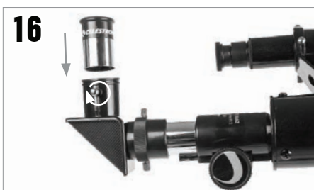
Placez l'oculaire de 20 mm dans le barillet du renvoi coudé comme illustré ci-dessus. Serrez la vis de fixation pour le maintenir en place.
