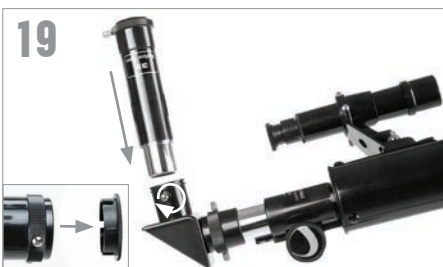
19 Para un aumento adicional puede usar la lente Barlow 3x incluida. Ponga la lente Barlow en el enfoque en lugar del ocular. Saque la tapa de la lente Barlow.
