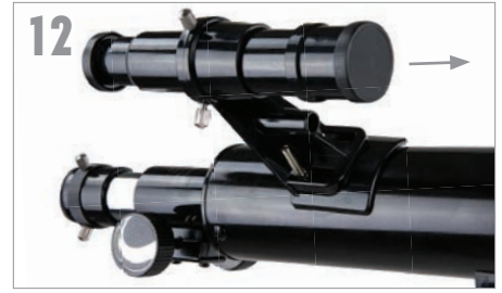
12 Oriente el localizador de forma que esté orientado a la parte anterior del tubo. Ponga el localizador sobre los tornillos del modo indicado.
