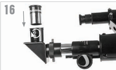
16 Ponga el ocular de 20mm en el cañón de la diagonal del modo indicado anteriormente. Apriete el tornillo para asegurarlo en posición
